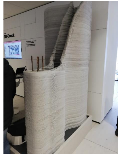
Abbildung 9: Peri 3D-Druck Außenschalung
